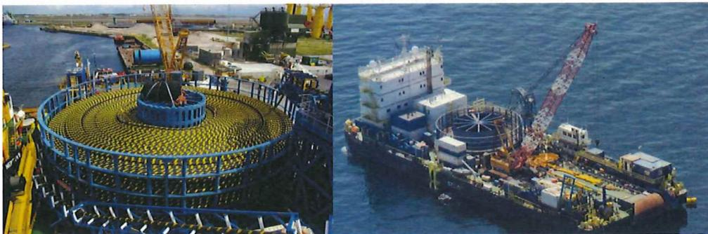
Figure 6 : Barge équipée d'un carrousel (source DONG Energy)
